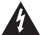
Der Blitz im gleichseitigen Dreieck weist auf gefährliche Hochspannung im Gerät hin.
