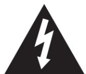
L'éclair et la flèche pointée dans le triangle représentent un symbole d'avertissement vous prévenant de 'tension dangereuse' à l'intérieur de l'appareil.
