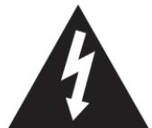
Symbol pioruna ze strzałką na tle trójkąta równo ramienego oznacza obecność niesiłowania prądem elektrycznym o napięciu wewnątrz obudowy urządzenia.
