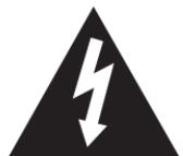
El rayo dentro de un triángulo es una señal de aviso acerca de un “peligro por tensión” dentro del producto.
